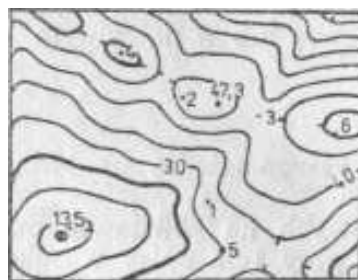
Rys. 158. Określenie wysokości punktu z interpolacji liniowej.
