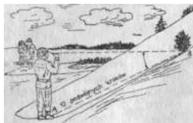
Rys. 52. Określanie kąta nachylenia terenu z pomiaru krokami.
