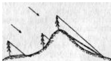
Rys. 200. Wielkość cienia w zależności od nachylenia terenu.
