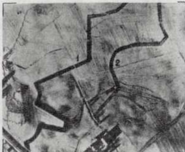
Zdj. 10. Zdjęcie zimowe w skali 1 : 7500 1. Żelbetowe słupy przeciwczołgowe 2. zapora z drutu kolczastego
