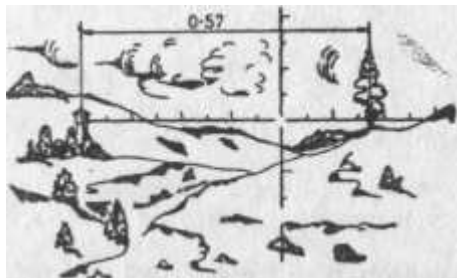
Rys. 37. Pomiar kąta lunetką busoli PAB-2.
