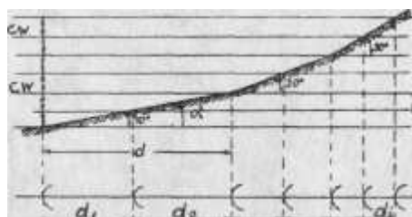
Rys. 159. Położenie warstwic w zależności od kąta nachylenia terenu.
