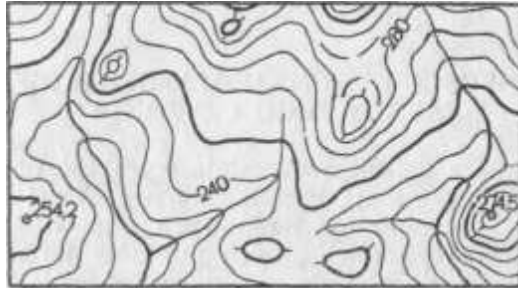
Rys. 150. Sieć wodna określa kierunki spadku terenu.
