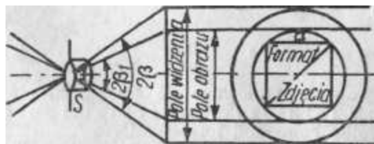
Rys. 181. Pole widzenia i pole obrazu kamery.
