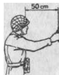
Rys. 42. Położenie ręki przy pomiarze kątów linijką milimetrową.
